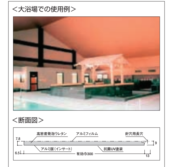
図4 浴室パネル建材の断面図
