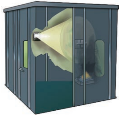
図 23. 3m キューブ試験
