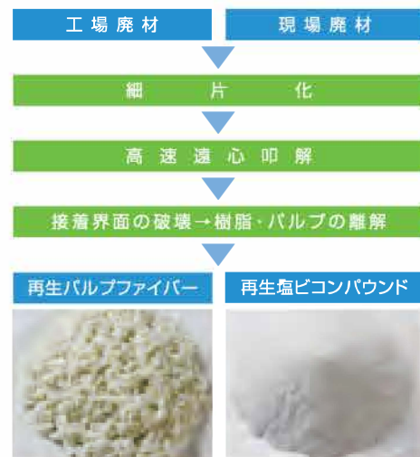
図2. 「壁紙再生システム」の処理フロー
