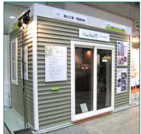
塩ビミニハウス(会場に展示) (樹脂サッシ、樹脂サイディングを施工)
