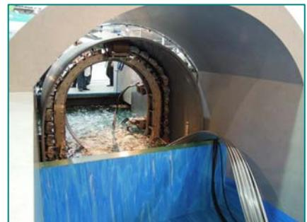
管更生工法 製管機小型モデル
