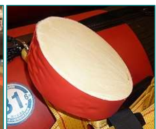
フォーム注入断面 カットサンプル (淡黄色部分がウレタン)
