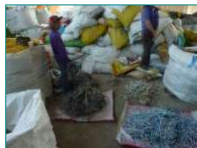
色分別後の廃ケーブル
