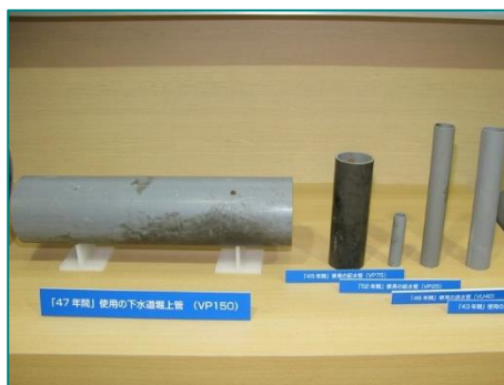
左：47年間使用のVU管 右：43～52年間使用の各種管
