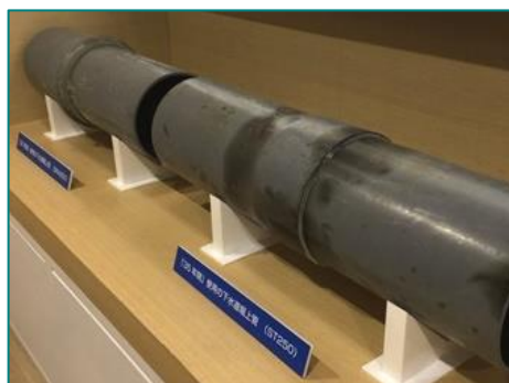
左：30年間使用の下水道管（SRA管） 右：35年間使用の下水道管（ST管）
