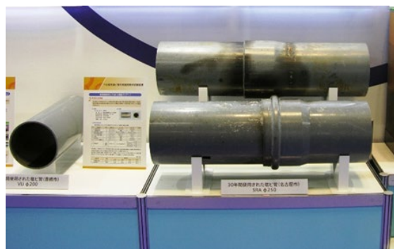
30年使用し埋設されていた塩ビ管
