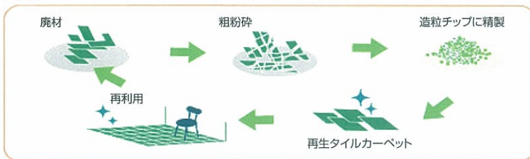
図7.タイルカーペトリサイクルシステムフロー図
