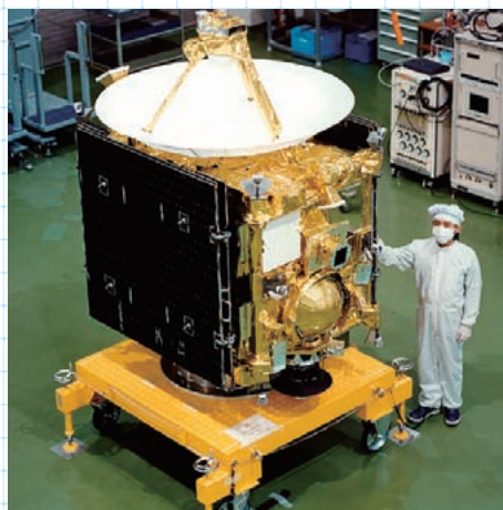
惑星探査機「はやぶさ」 耐熱材としてプラスチック（ポリイミド系）が使用されている。金属を蒸着したシート状で、写真では金色に見える部分。
