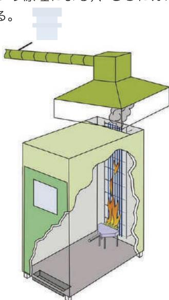
図 25. EN 50399 の複数敷設延焼性試験と排気ダクト
