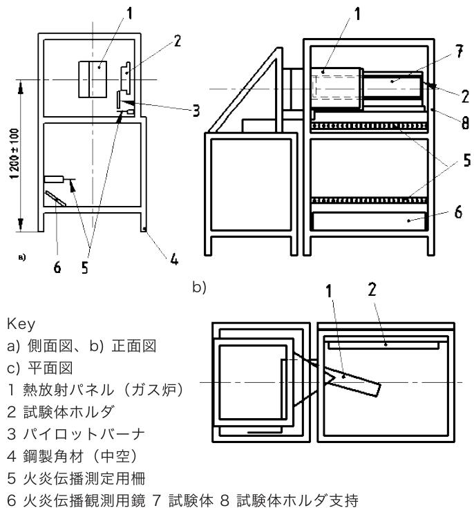
図 7. FTP コード パート 5 試験装置
