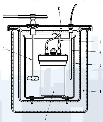
1 搪拌器 2 ふた 3 着火用電気入力線 4 温度計（熱電対）
