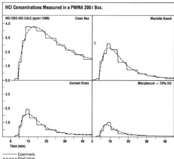
図3. PMMA 製ボックスで塩ビケーブルの熱分解から生成する HCl ガス濃度の測定値<sup>(8)</sup>
