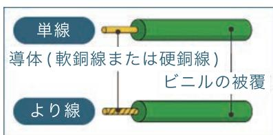
図 19. 塩ビ絶縁電線（単線）の例
