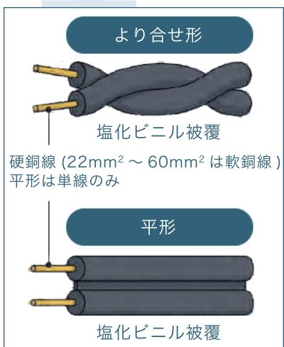
図 20. 塩ビ絶縁電線（2条）の例
