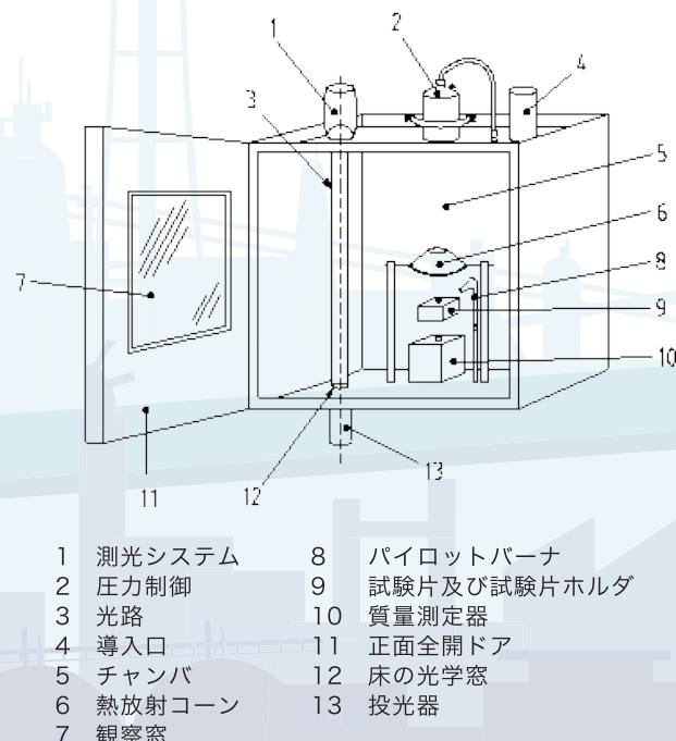
図6. ISO 5659-2 発煙性試験の試験装置
