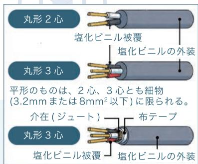
図 21. 塩ビ絶縁・被覆電線ケーブルの例
