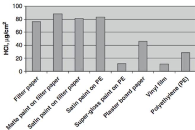
図4. 壁材に吸着した HCl ガス濃度の測定値<sup>(9)</sup>
