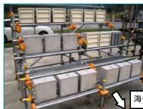
試験体の暴露状況と表面被覆
