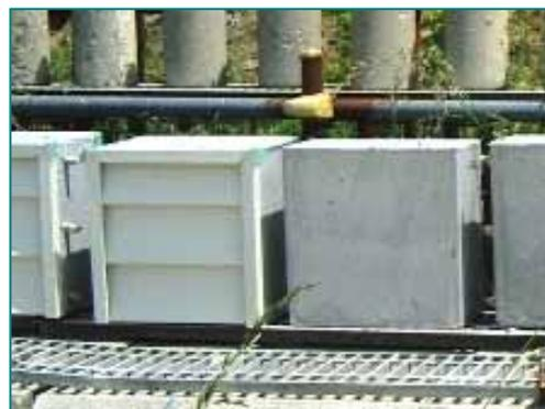
暴露1年経過のコンクリート試験体
