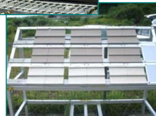
コンクリート試検体(上) / 塩ビサイディング試検体(下)
