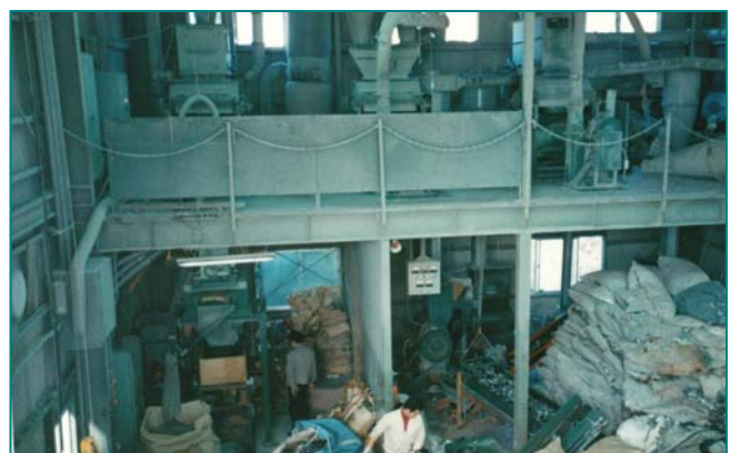
愛知県扶桑町で始めてしばらくした頃のPVCレザーの粉碎分離設備と作業風景
