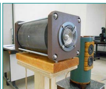
写真4. 150肉厚ソケット管バスレフ(左) 積層パツフル塩ビ管バスレフ(右) (古館@横浜さん作)
