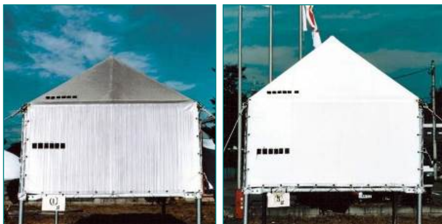
写真 1. PVC テントの 5 ヶ月屋外暴露状況 (左：酸化チタン光触媒なし、右：酸化チタン光触媒コート)
