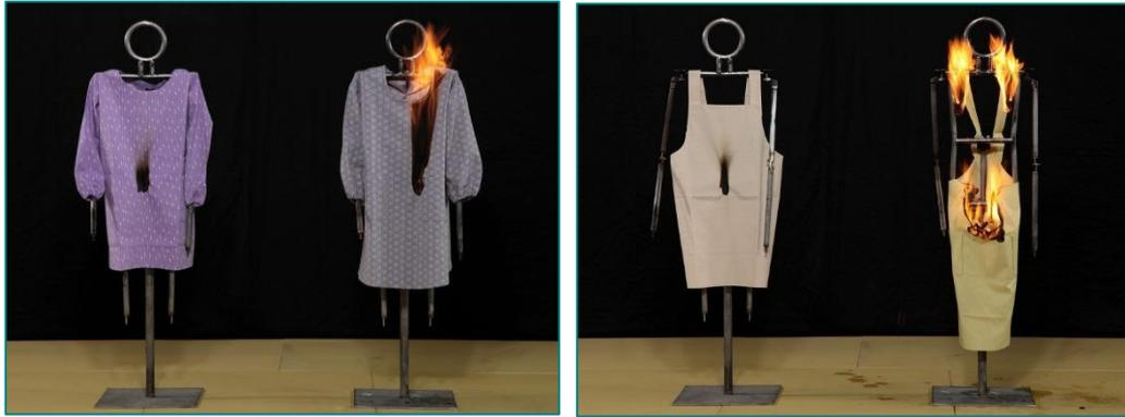
左；防災製品、右；非防災製品、いずれも同時着火して約 50 秒経過後の状況
