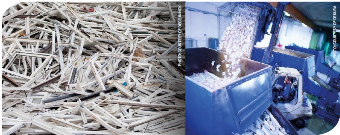
左：回収された窓枠 右：窓枠を裁断している様子
