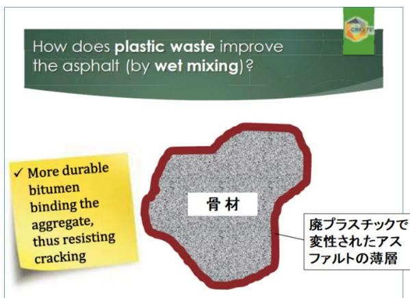
図1. 廃プラが骨材とアスファルトのバインダーに
