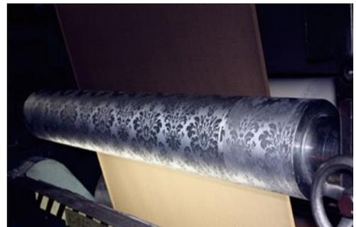
グラビア工程では、グラビア印刷機を使用してこの原反に柄や模様を印刷します。彫刻されたロールの凹部に印刷インクを付け、原反に転写して絵柄をつけます。これにより、壁紙に細かいデザインや模様を表現できます。壁紙に多様なデザインが施せるのはグラビア工程があるからです。その後、発泡エンボス工程に進みます。ここでは、印刷された原反を約200℃に加熱し、原反の塩ビ層に含まれる発泡剤を膨れさせます。そして、発泡して厚みのでた塩ビ層を金型（エンボスロール）で押すことで凹ませ、意匠性を付与します。
