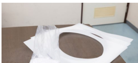
照明カバーの加工端材 チップにして再利用
